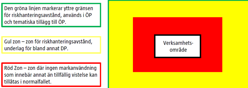
Figur 3. Illustration över riskhanteringsavståndet och tänkt användning för brandfarliga gaser, brandfarliga vätskor och oxiderande ämnen. Den gröna linjen bygger på överslagsberäknad konsekvens för skada på människor och bortanför denna gräns kan etablering av annan verksamhet normalt vara möjlig. En planeringssituation inom den gula zonen innebär att man befinner sig inom riskhanteringsavståndet vilket kräver vidare analyser för att avgöra möjligheten för fortsatt planering. Den röda zonen är normalt olämplig att använda för markanvändning som innebär stadigvarande vistelse i området [5].
