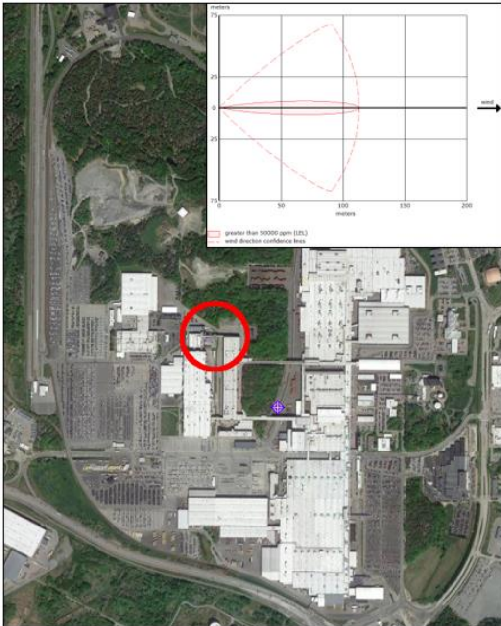
Figur 9. Konsekvensområde (100% LEL) för ett fullständigt rörbrott vid en antagen rörledning om 50 cm och ett tryck om 4 barg.
